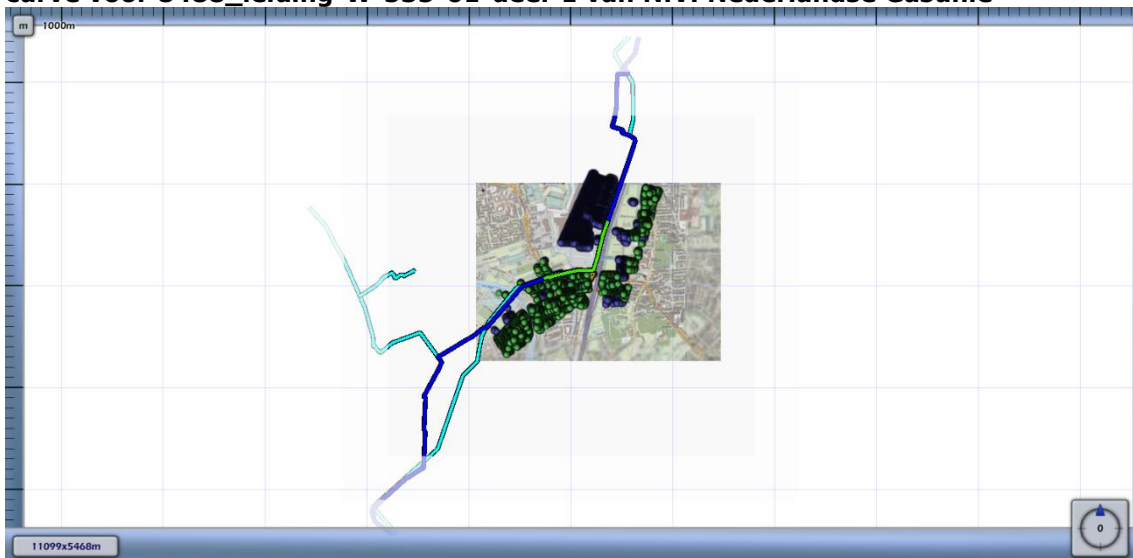
Figuur 4.2 Kilometer leiding behorende bij de maximale overschrijding van de FN-curve voor 8488_leiding-W-535-01-deel-1 van N.V. Nederlandse Gasunie
