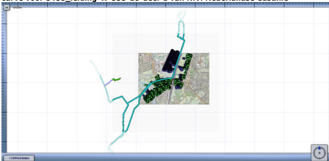
Figuur 4.5 Kilometer leiding behorende bij de maximale overschrijding van de FN-curve voor 8488_leiding-W-535-18-deel-1 van N.V. Nederlandse Gasunie
