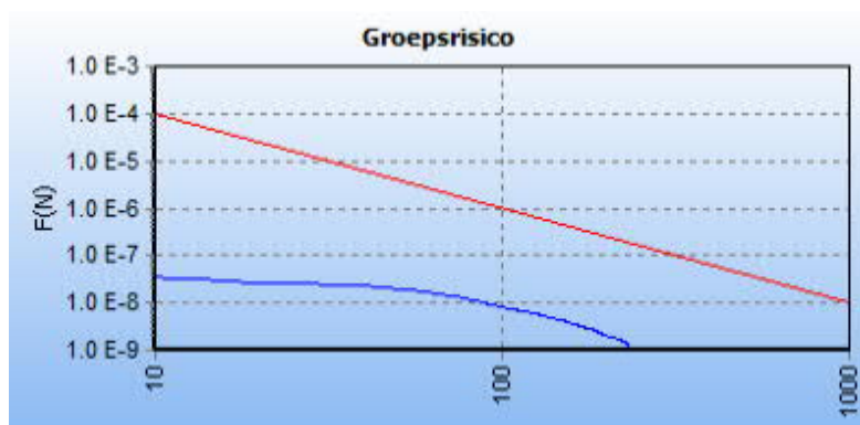
Afbeelding 8 fN-curve buisleiding A-560-deel-1, na planrealisatie
