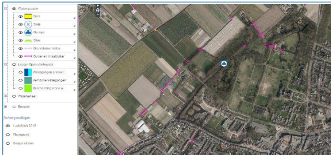
Figuur 3.5 Uitsnede digitale legger met technische voorzieningen, het symbool in het midden van de figuur geeft de locatie van het inlaatgemaal weer (Hoogheemraadschap van Rijnland, 2016)
