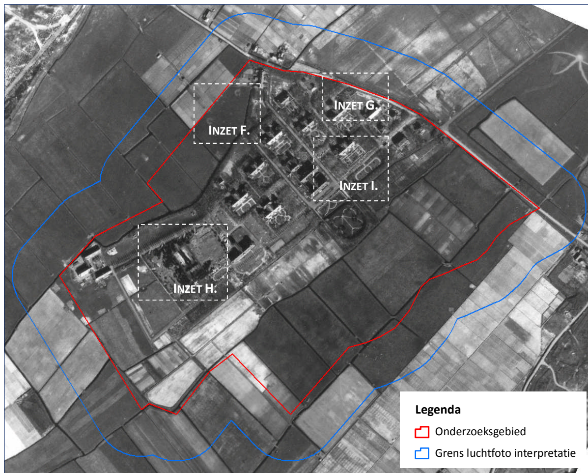
Figuur 15: Uitsnede luchtfotonummer 3013, sortie 106G-5133, 30 maart 1945. In het onderzoeksgebied zijn een tweetal geschutsbeddingen met een opstellingsinrichting voor een ondersteunende voorziening ( Inzet F. ) waarneembaar. Bij de Langevelde laan en op het terrein van Sancta Maria zijn er loopgraven, versterkte onderkomens, schutterputten/schuilgaten, stellingen en/of opslagvoorzieningen of opstelplaatsen zichtbaar ( Inzet G. ). Voor inzet H. zie figuur 16 en voor inzet I. figuur 17 .
