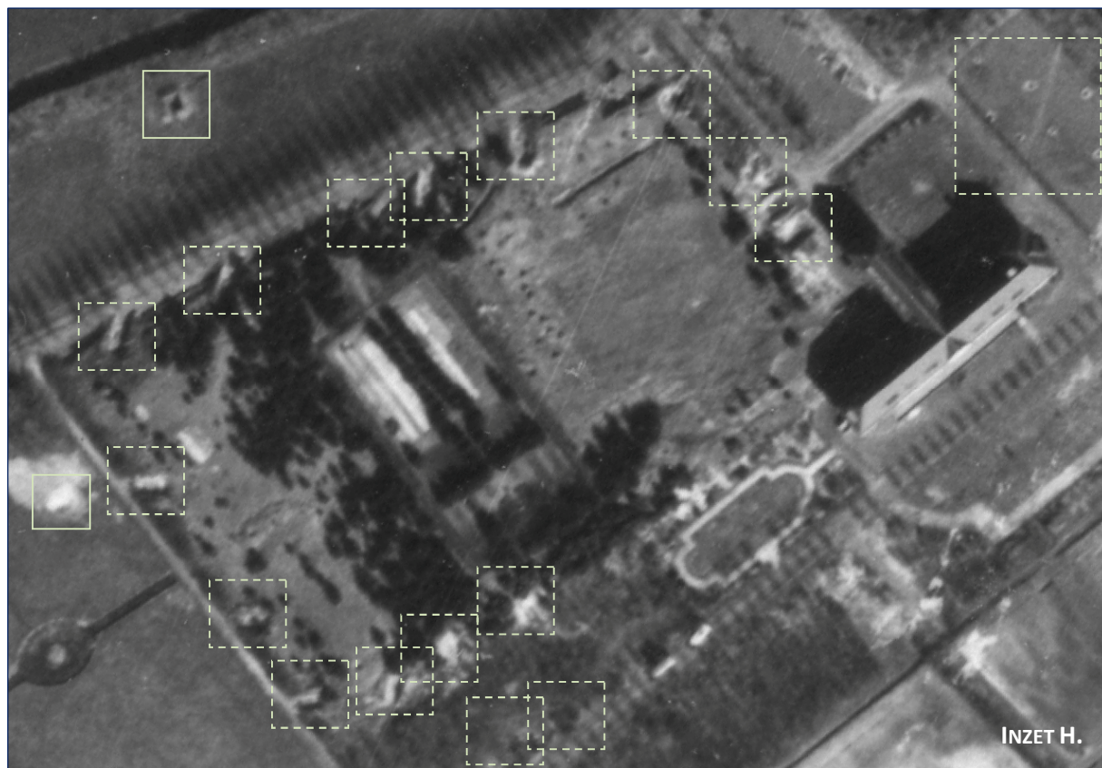
Figuur 16: Weergave inzet H. , uit figuur 15 . Rondom het kerkhof zijn in vergelijking tot de luchtfoto van 10 september 1944 een groter aantal constructies zichtbaar, welke mogelijk bedoeld zijn voor opslag of als opstelplaatsen voor voertuigen. Een deel van de stellingen rondom de boerderij zijn verwijderd. Verder zijn er schuilgaten zichtbaar.
