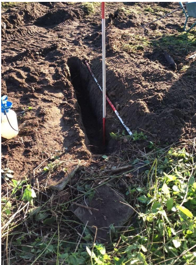
Foto 3: opname inspectiesleuf SL02 nader asbestonderzoek voormalige schuur
