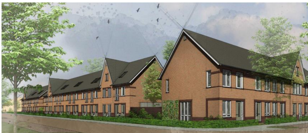
Afbeelding 3 Impressie ligging tuinmuur van 2,2 meter tussen blok B en blok D (creëren geluidsluwe buitenruimte)
