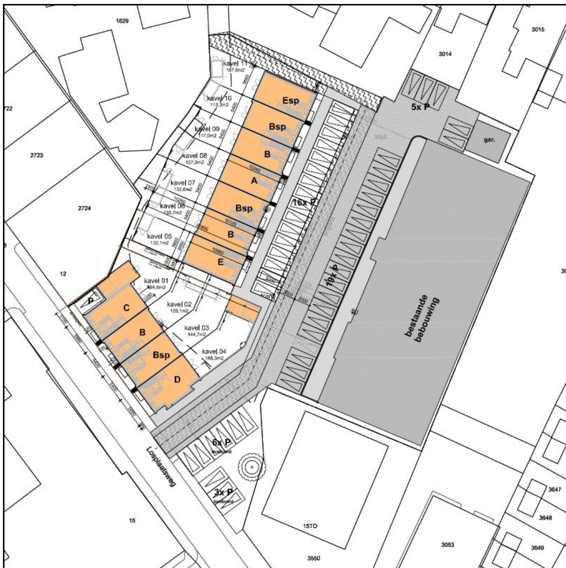
Afbeelding 6: Overzicht aanwezige parkeerplaatsen na realisatie bouwplan fase 1.
