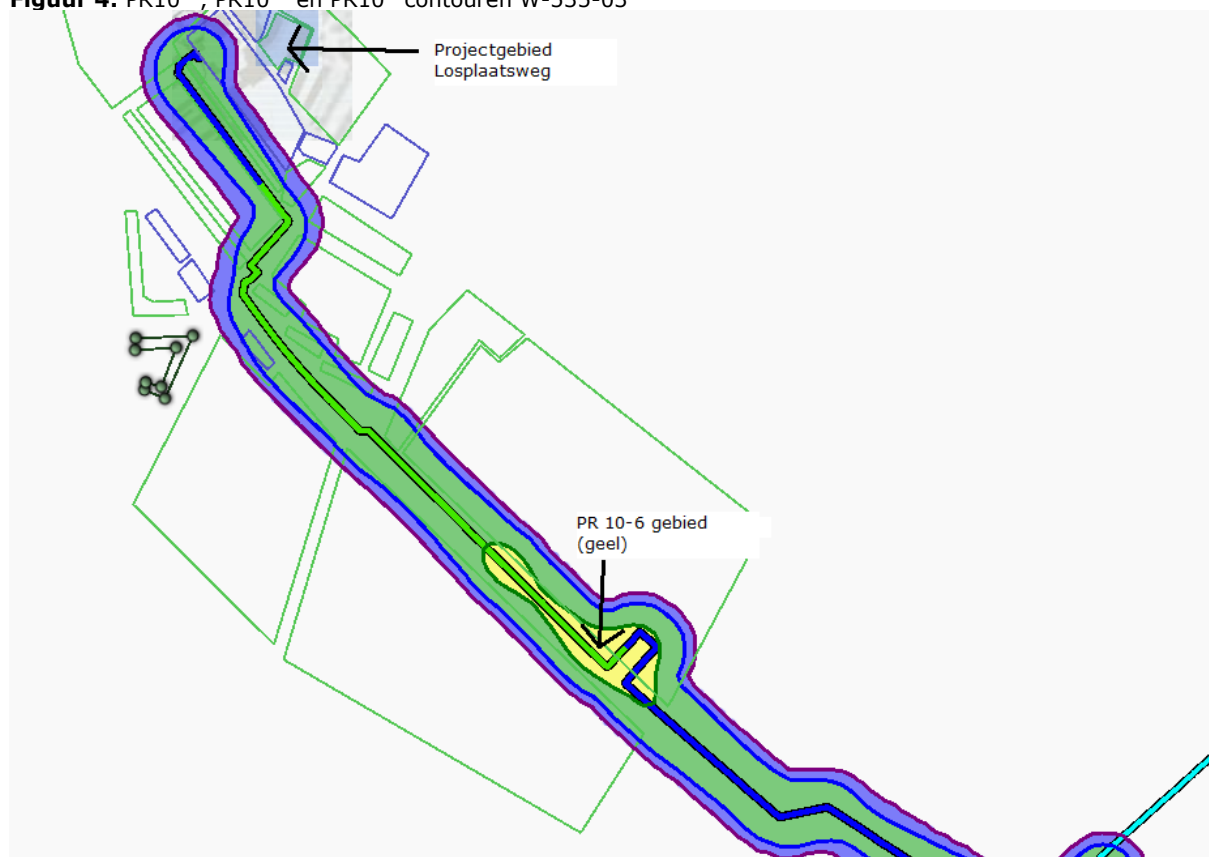
Figuur 4: PR 10^{-6} , PR 10^{-7} en PR 10^{-8} contouren W-535-03
