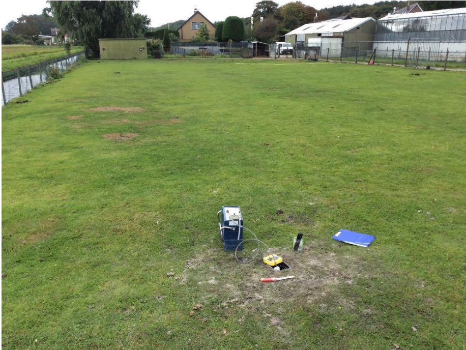
Foto 5: geplaatste peilbuis, boring nummer 12
