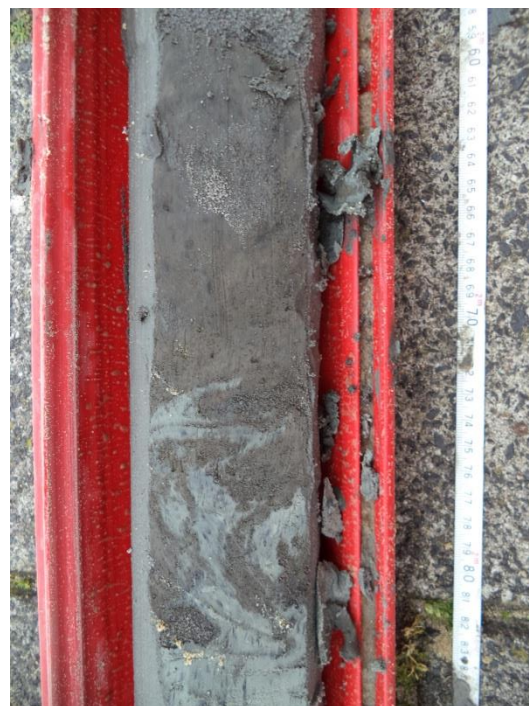
Figuur 6: Foto van een deel van boorkern 13 tussen 8,58 m –mv (bovenaan de foto) tot 8,86 m –mv (onderaan de foto). Duidelijk zichtbaar is de rommelige overgang tussen de grijze klei onderin en de humeuze klei bovenin, tussen 8,72 en 8,83 m –mv.
