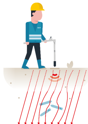
Figuur 3: Werkingsprincipe passieve detectie
