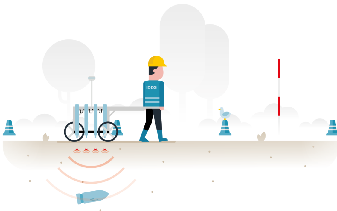
Figuur 5: Werkingsprincipe non-realtime oppervlakedetectie.
