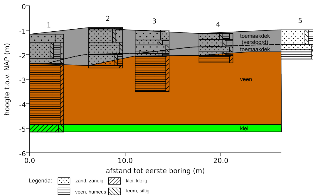
Figuur 22: Schematische doorsnede. De boorprofielen zijn getekend in overeenstemming met NEN5104.
