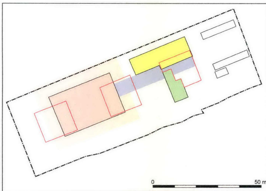
Figuur 1. Huidige bebouwing (zwarte lijn), toekomstige bebouwing (rode lijn) en verstoringen van de bodem door een mestkelder (roze), puinlaag (lichtroze), kabels en leidingen (blauw), de huidige woning (groen) en een schuur (geel) binnen het perceel (zwarte streep-puntlijn).
