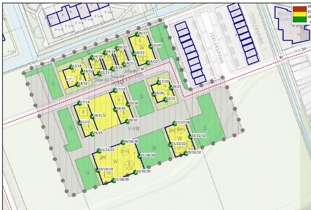
Uit de berekeningen wordt geconcludeerd dat er vanwege de W.P. Speelmanweg geen overschrijding plaatsvindt van de voorkeursgrenswaarde, de hoogste geluidsbelasting bedraagt 35 dB. Vanwege de W.P. Speelmanweg wordt voldaan aan de Wgh.
