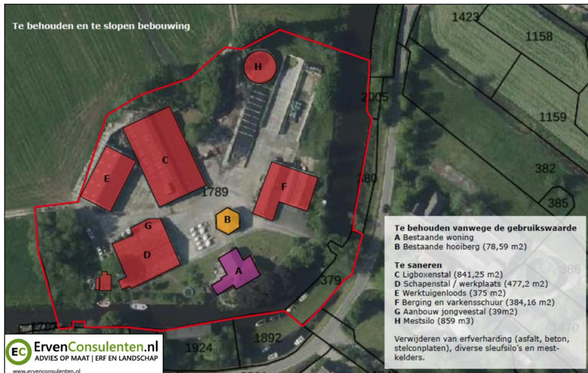
Afbeelding 2.4 De te slopen bebouwing in het plangebied (Bron: ErvenConsulenten.nl)
