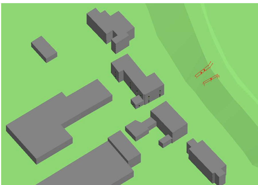
Figuur 3: 3D-afbeelding geluidmodel met geluidbronnen (rood) en rekenpunten (zwart)
