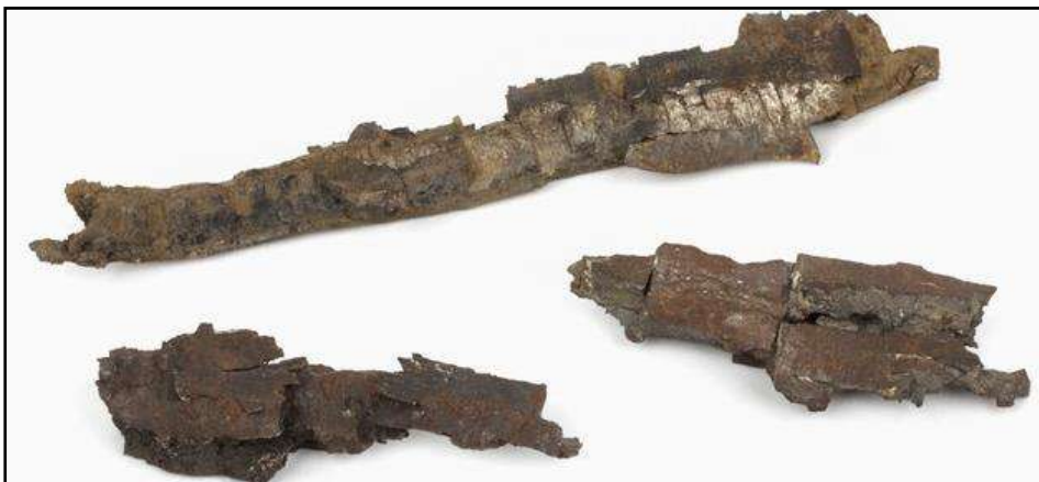
Figuur 26. Scherven afkomstig van een projectiel dat was gevuld met springstof, na detonatie.
