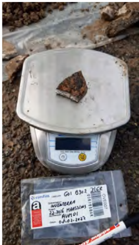
Asbestverdacht materiaal in G01
