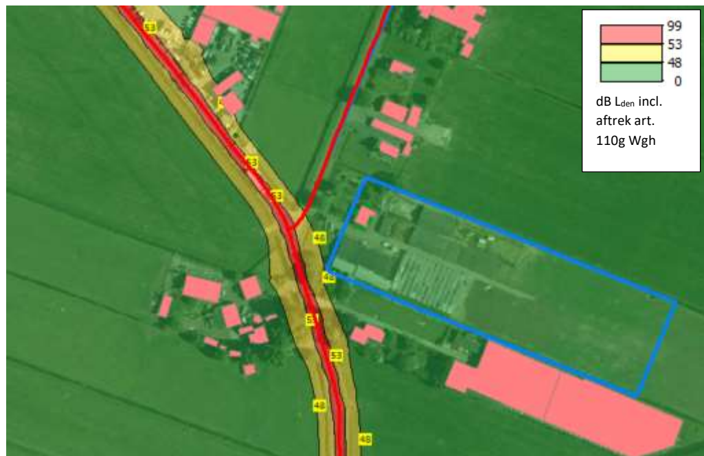
Figuur 5 Geluidscontouren voor de Rooversbroekdijk (4,5 meter beoordelingshoogte)
