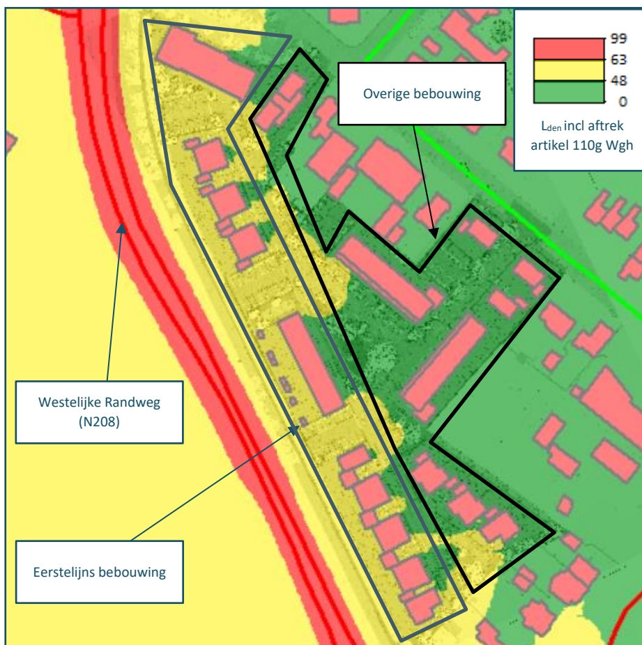
Figuur 5 Contouren van de geluidsbelasting vanwege wegverkeer op de N208 (incl. 5 dB correctie artikel 110g Wgh) op 7,5 meter beoordelingshoogte
