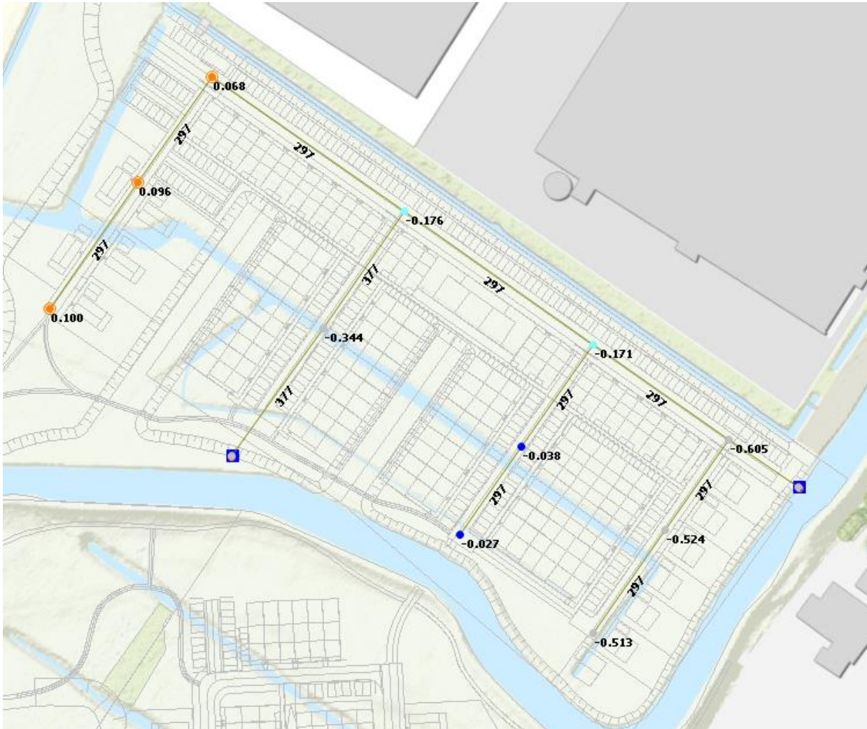
Figuur 4-24 Toetsing bui 10, met waterdiepte op putniveau
