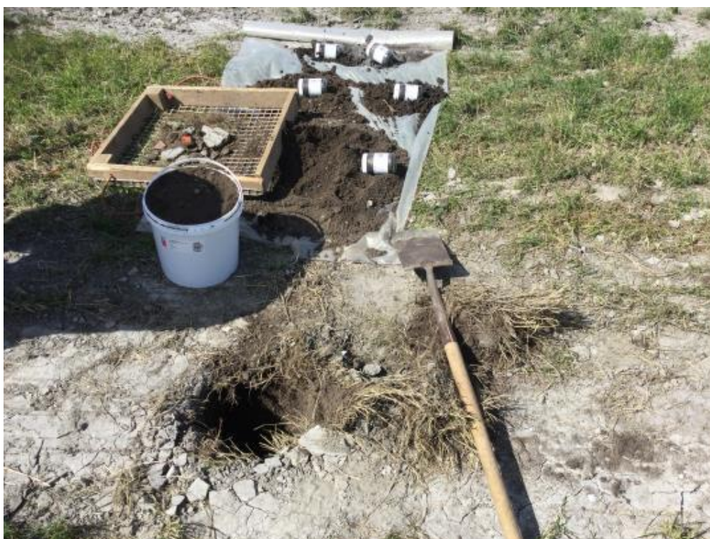
Asbest gat locatie Puingrond.
