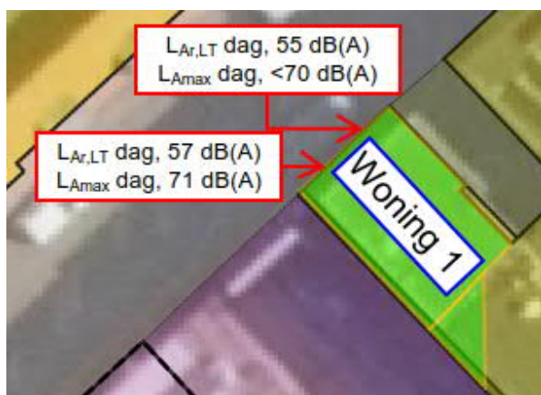
Figuur 6: Gevel met overschrijding geluidbelasting
