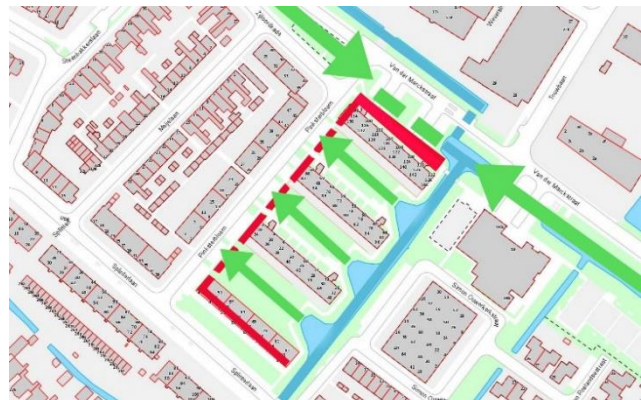
Figuur 3 Schematische weergave rooilijnen (rood) Pinksterbloem
