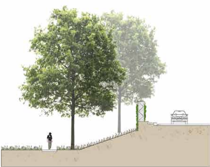
Doorsnede begroeid geluidscherm (deels keerwand)
