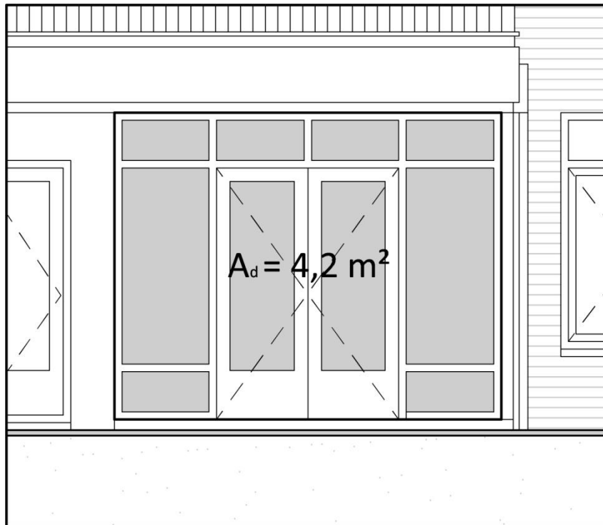
Figuur 1 – Oppervlakte doorlaat raam 1
