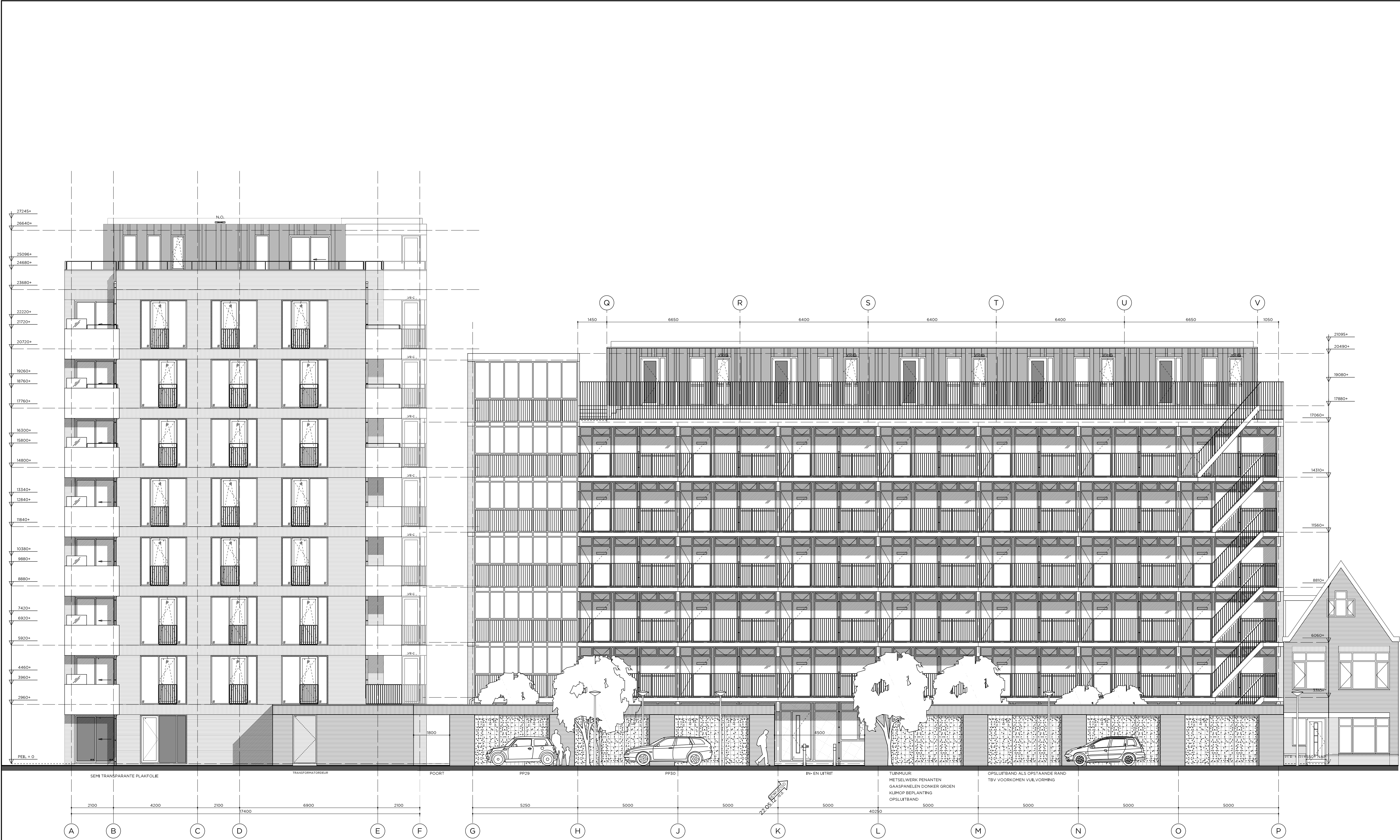
NOORDGEVEL BOUWDEEL A
