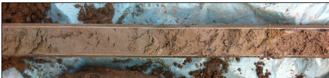
Afbeelding 14 Roestvlekken in de oeverafzettingen (boring 18).
