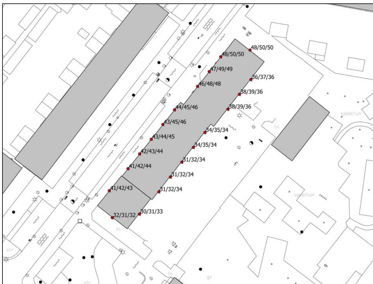
Figuur 5.1: overzicht geluidbelastingen Koninginnelaan.
