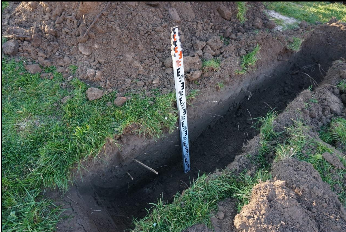
Foto 7: Sleuf 1 op 7,5 meter van boom 117 waarbij veel kleine wortels in de bovenlaag zijn aangetroffen.
