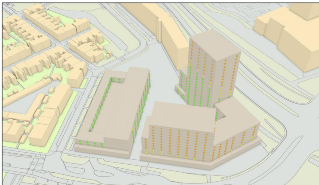
Afbeelding 10: 3D-weergave geluidsbelasting (groen ≤ 55 dB, geel = 56 t/m 58 dB en oranje = 59 t/m 63)
