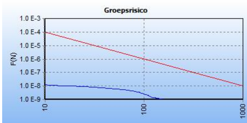
5.7 Figuur 5.7 FN curve voor 8777_leiding-W-535-14-deel-1 van N.V. Nederlandse Gasunie voor de kilometer tussen stationing 0.00 en stationing 0.00
