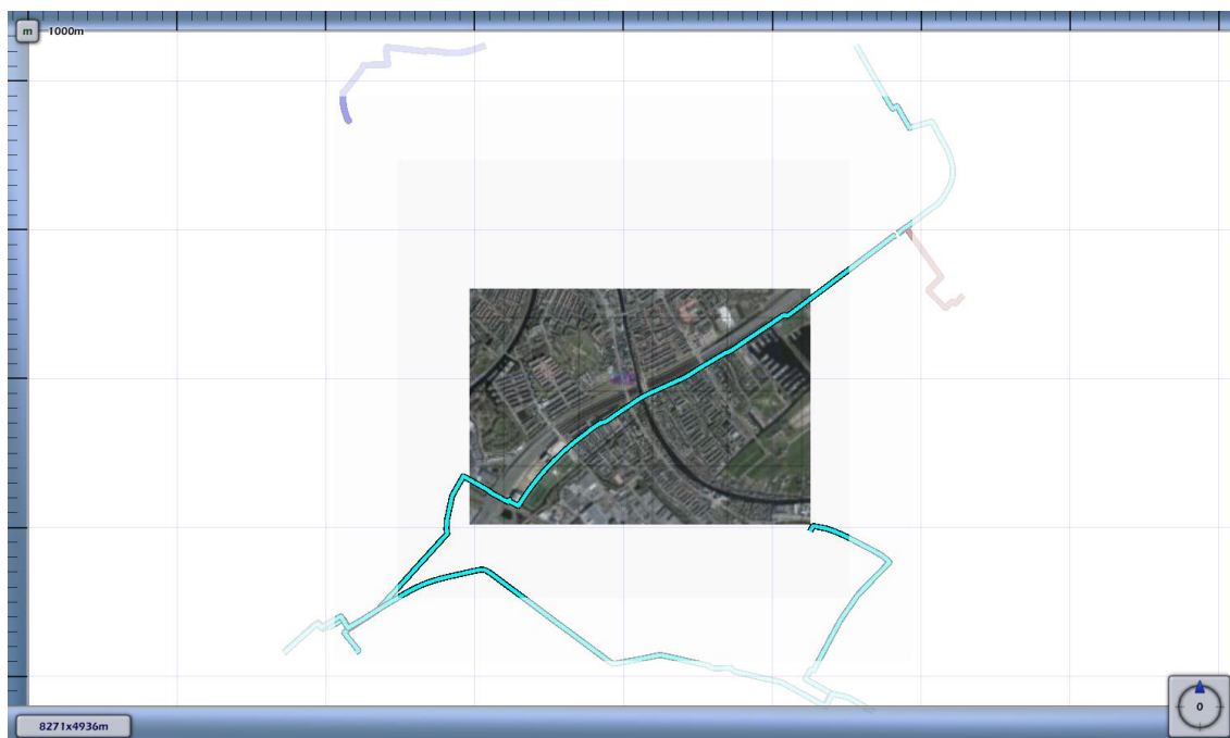
3.6 Figuur 3.6 Plaatsgebonden risico voor 8777_leiding-W-535-11-deel-1 van N.V. Nederlandse Gasunie
