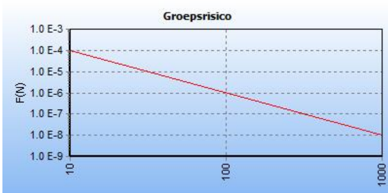
5.2 Figuur 5.2 FN curve voor 8777_leiding-A-515-deel-1 van N.V. Nederlandse Gasunie voor de kilometer tussen stationing 2670.00 en stationing 3590.00
