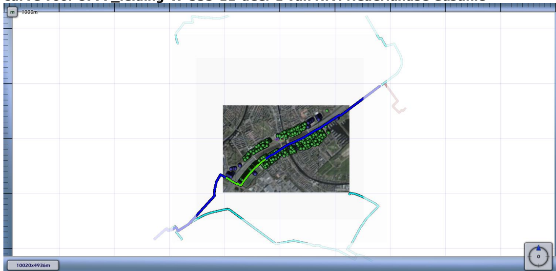
Figuur 4.6 Kilometer leiding behorende bij de maximale overschrijding van de FN-curve voor 8777_leiding-W-535-11-deel-1 van N.V. Nederlandse Gasunie
