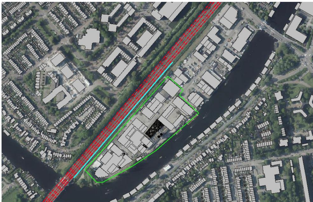
Figuur 4: Maatregel 3 meter hoog absorberend geluidscherm
