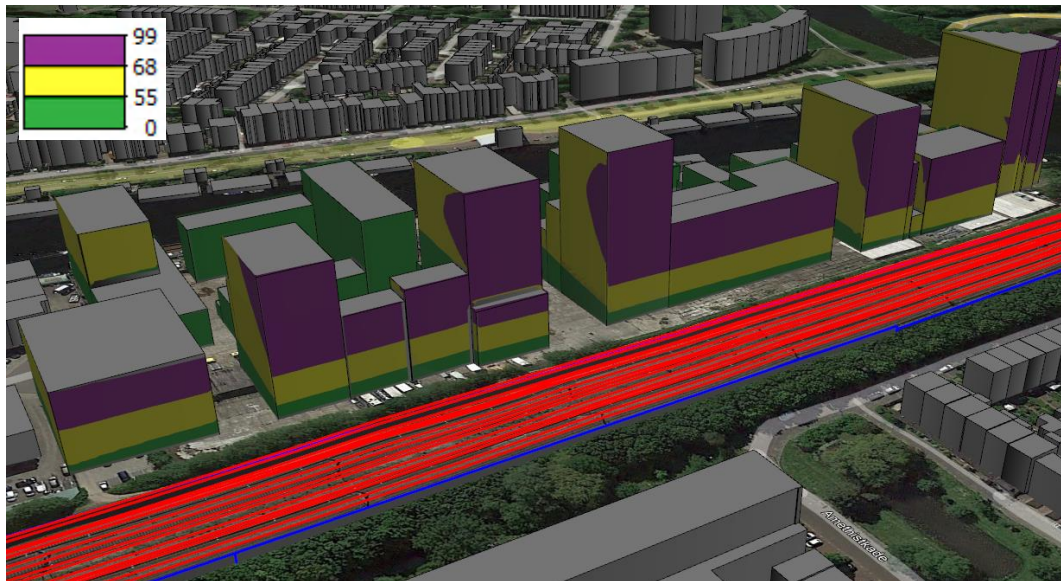
Afbeelding 5.2 Geluidbelasting variant 1 inclusief maatregel 3 meter hoog scherm
