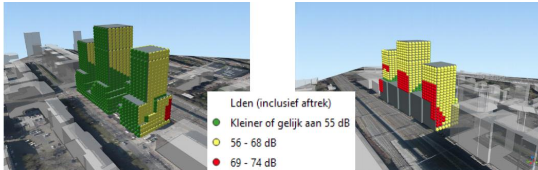
Afbeelding 5: Geluidbelasting railverkeer, Lden in dB
