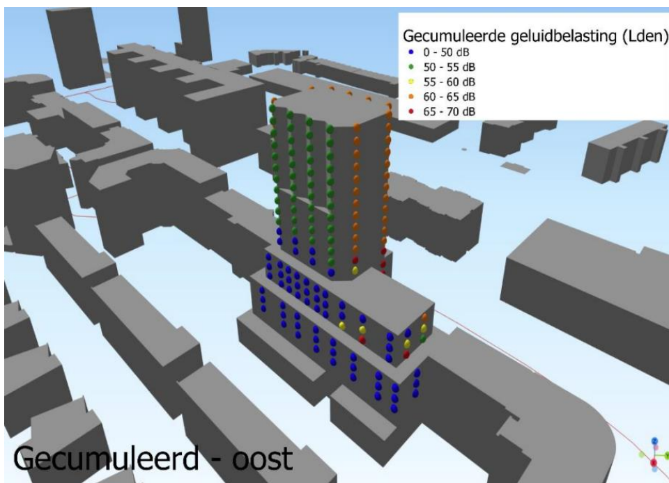
Afbeelding 6b: Gecumuleerde geluidbelasting (inclusief correctie railverkeer) in dB
