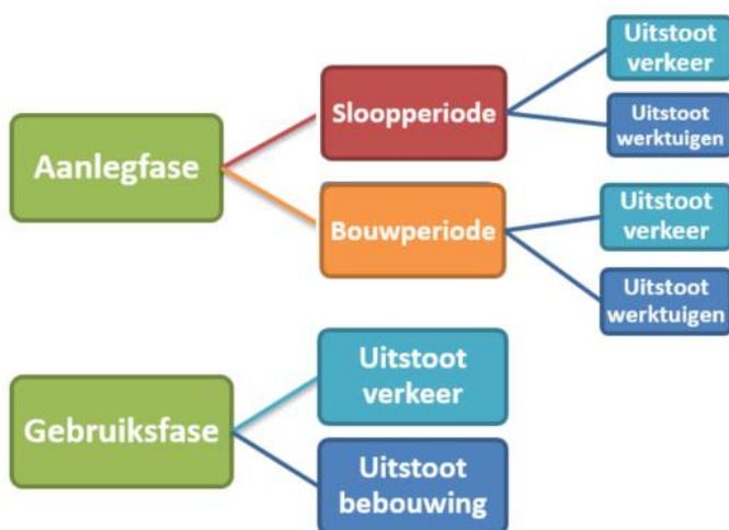
Afbeelding 3: Indeling aanlegfase en gebruiksfase
