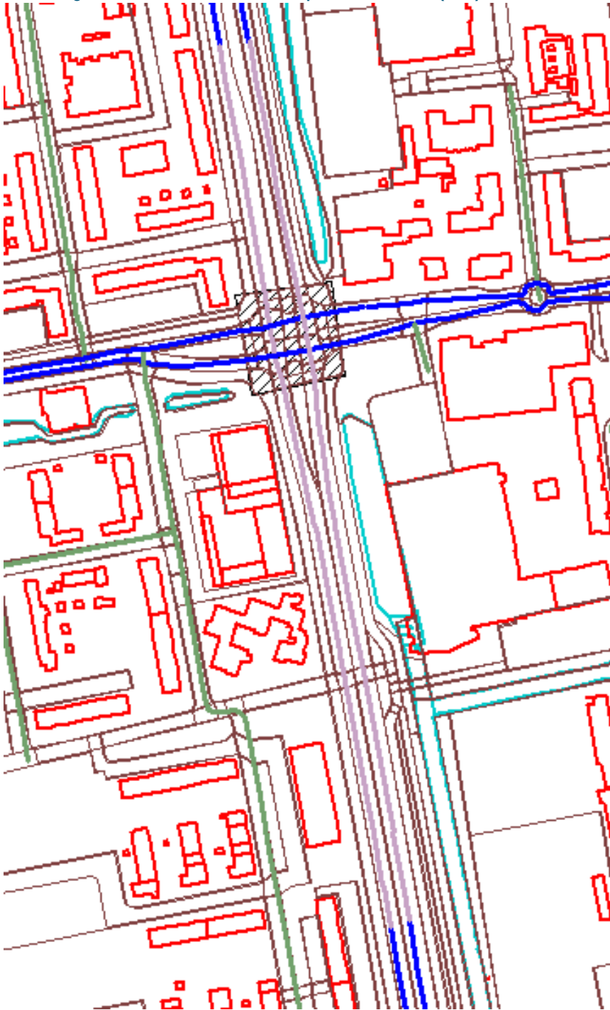
Afbeelding 12 – Geluidreducerend asfalt op de churchilllaan (roze)
