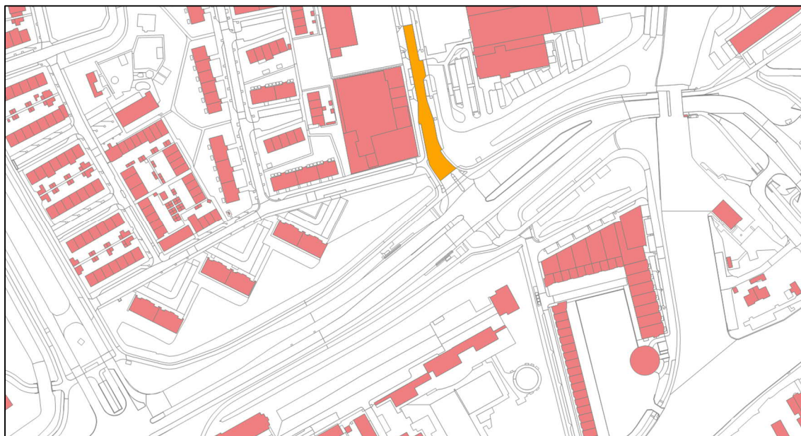
Afbeelding 19 Onderzocht stiller wegdek (oranje vlak) bestaande uit SMA-NL8G+ op de Rooseveltstraat
