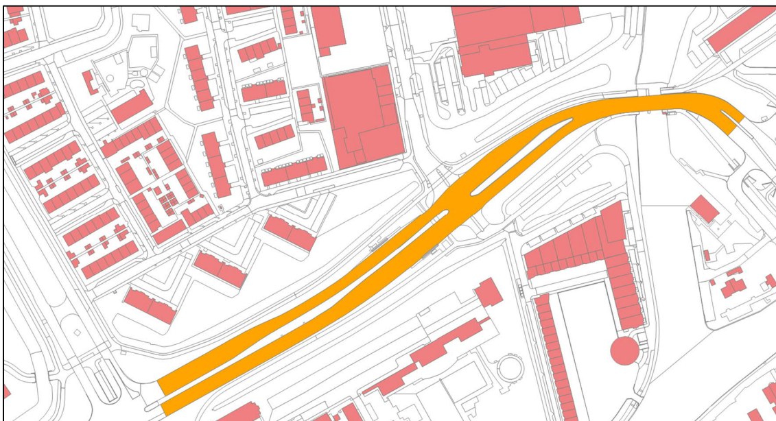
Afbeelding 21 Onderzocht stiller wegdek (oranje vlak) bestaande uit SMA-NL8G+ op de Voorschoterweg (N206/N447)
