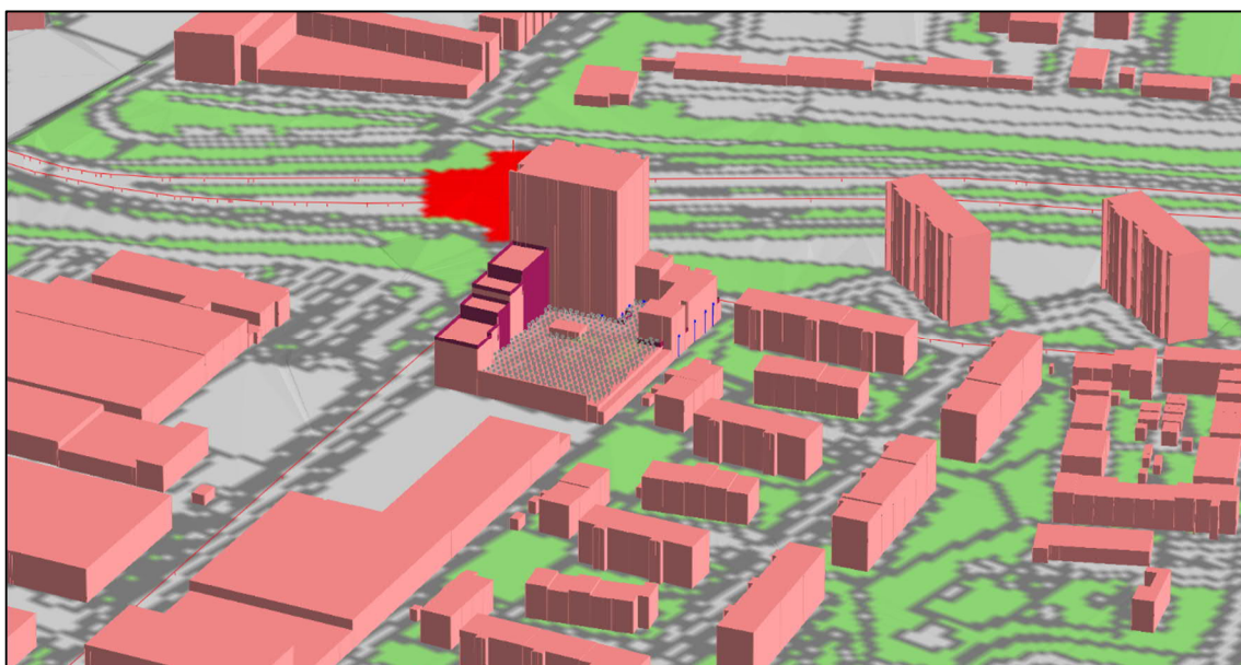
Afbeelding 7 3D-weergave computersimulatiemodel wegverkeerslawai (model 1 e verdieping - binnenzijde)
