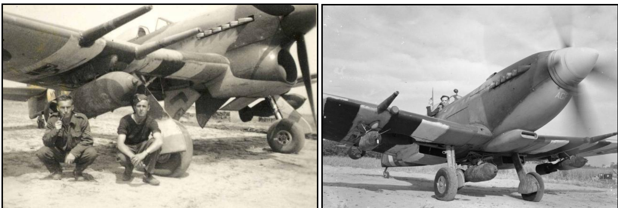
Figuur 18. Britse 1000 lb. MC bommen opgehangen onder de vleugels van een Hawker Typhoon jachtbommenwerper (links). De Super Marine Spitfire jachtbommenwerper (rechts) is voorzien van twee 250 lb. GP bommen onder de vleugels en één 500 lb. MC bom midden onder het vliegtuig.
