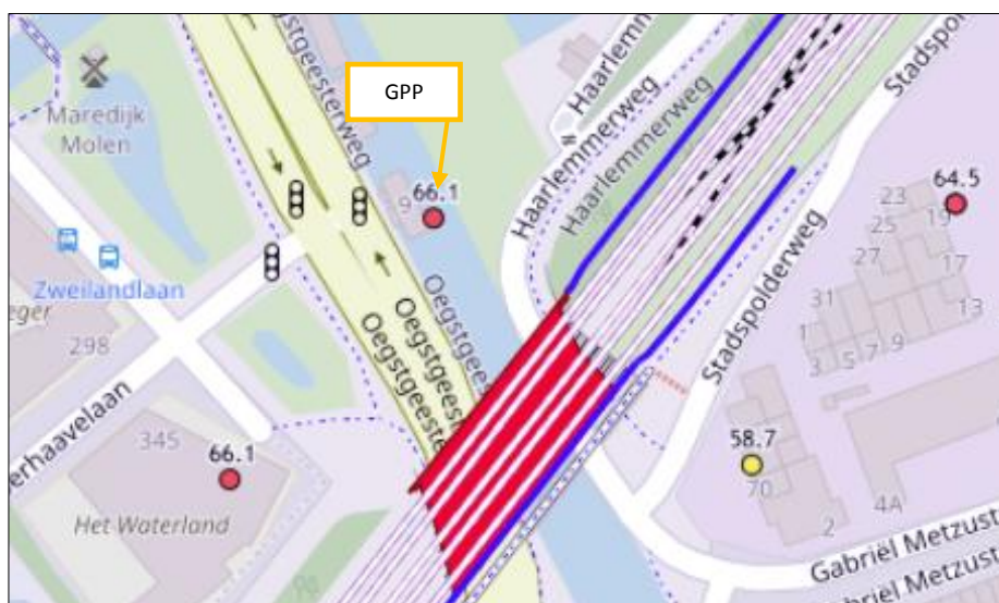
Figuur 2 Geluidproductieplafond voor bepaling zonebreedte railverkeerslawaa
