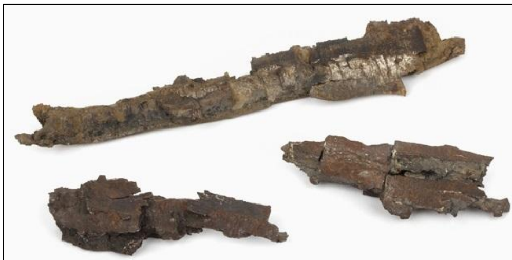
Figuur 25. Scherven afkomstig van een projectiel gevuld met springstof, na detonatie.
