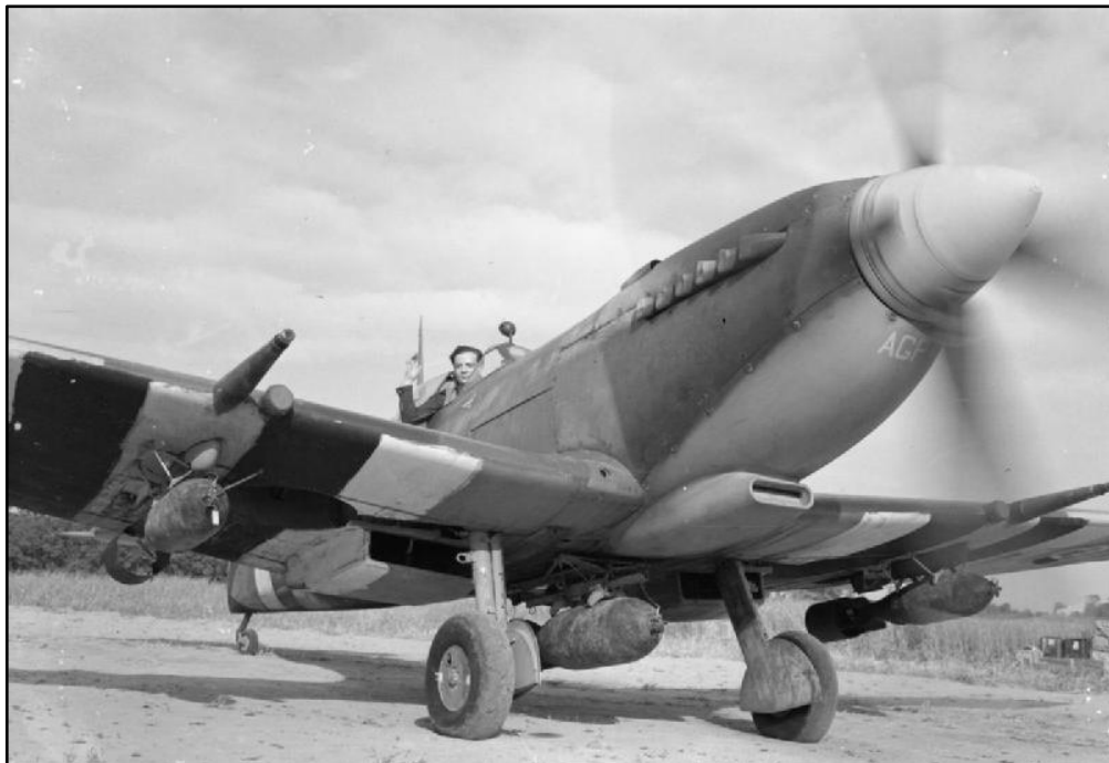
Figuur 6: Een Super Marine Spitfire jachtbommenwerper met twee 250 lb. brisantbommen opgehangen onder de vleugels en één 500 lb. brisantbom opgehangen midden onder het midden van het vliegtuig (bron: http://en.wikipedia.org/wiki/Geoffrey_Page ).
