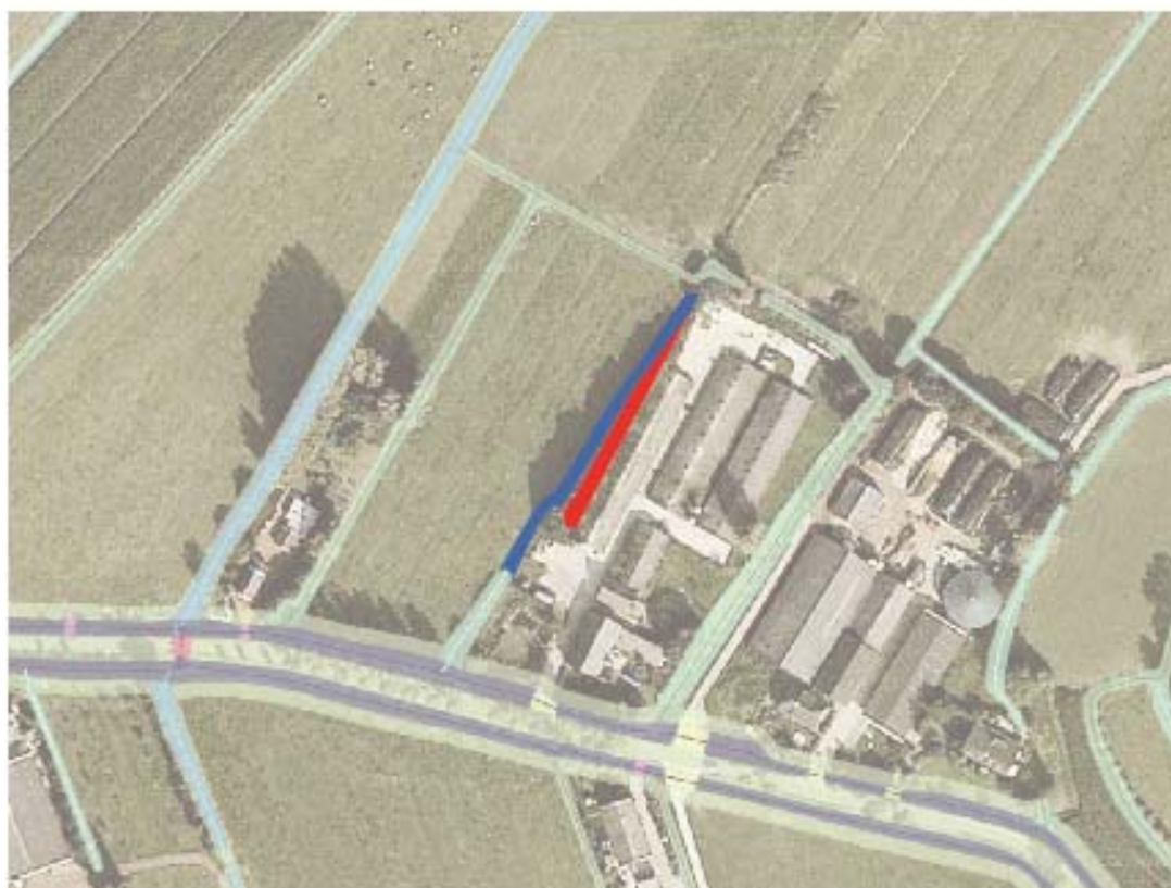
Afbeelding 12: conceptlegger 2014 (boven) en voormalige (rood) en nieuwe (blauw) watergang (onder)
