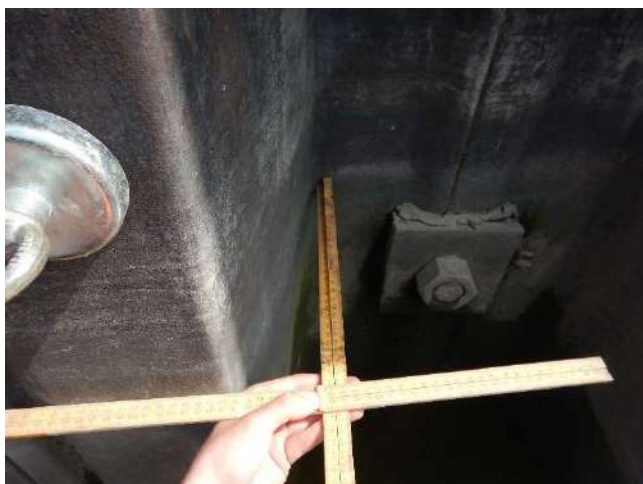
figuur 4.1: Gemeten hoogte damwandprofiel (295 mm)
