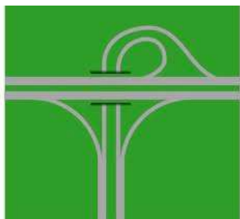
Figuur 2.2 Principe van de trompetoplossing
