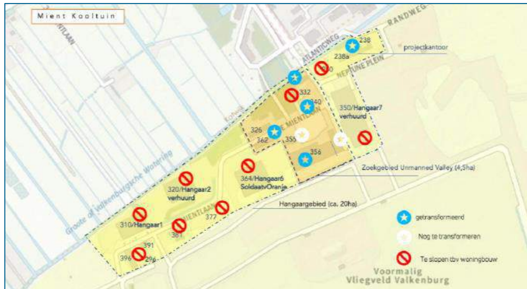
Figuur 3-2: Transformatie en sloop binnen het hangaargebied.
