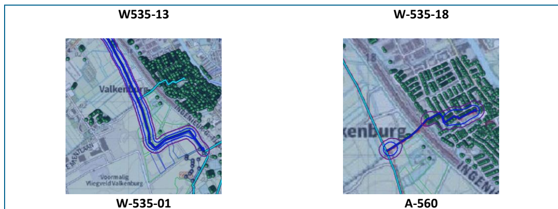
Figuur 5.2 Plaatsgebonden risicocontouren PR 10^{-6} contour rood (ontbreekt), PR 10^{-7} blauw, PR 10^{-8} paars
