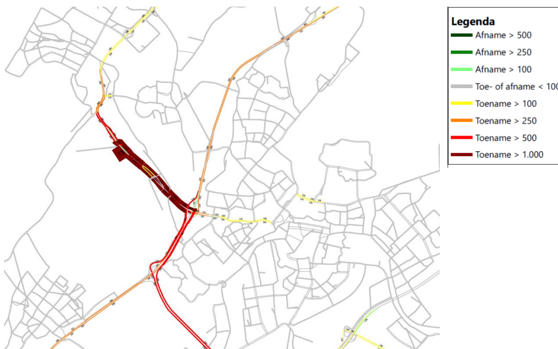
Figuur 3-5: Verschilplot Intensiteiten, motorvoertuigen, etmaalperiode: Situatie 2030: Variant 1500 woningen t.o.v. 2030 autonoom
