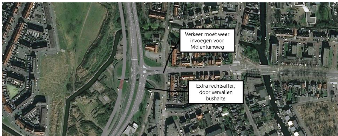
Figuur 5-26: Netwerkoverzicht extra opstelstrook voor rechtsaf
