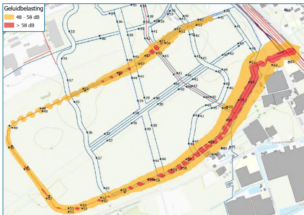
Afbeelding 4.14 Geluidcontouren Torenlaan/Woordtmanlaan op 1,5 meter hoogte
