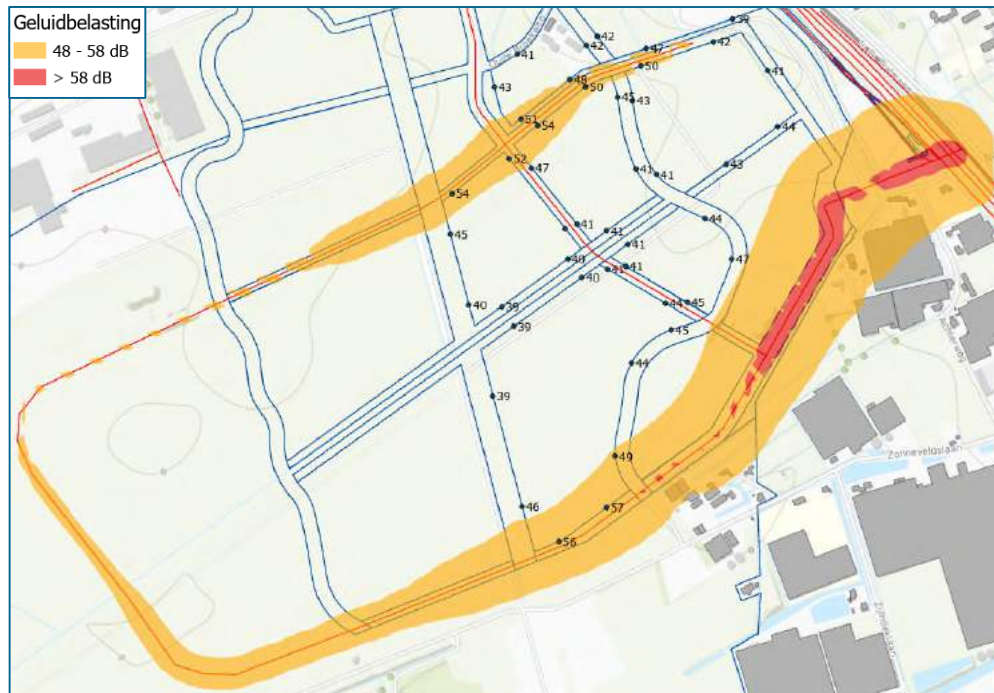
Afbeelding 4.16 Geluidcontouren Torenlaan/Woordtmanlaan op 13,5 meter hoogte
