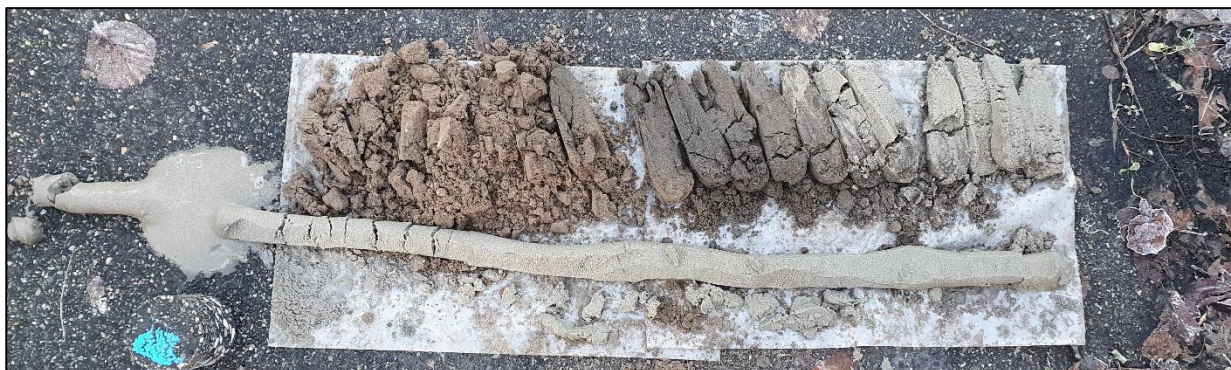
Boring 1 (geheel). Het diepste punt van de zuigerboor bevindt zich aan de rechterzijde.
