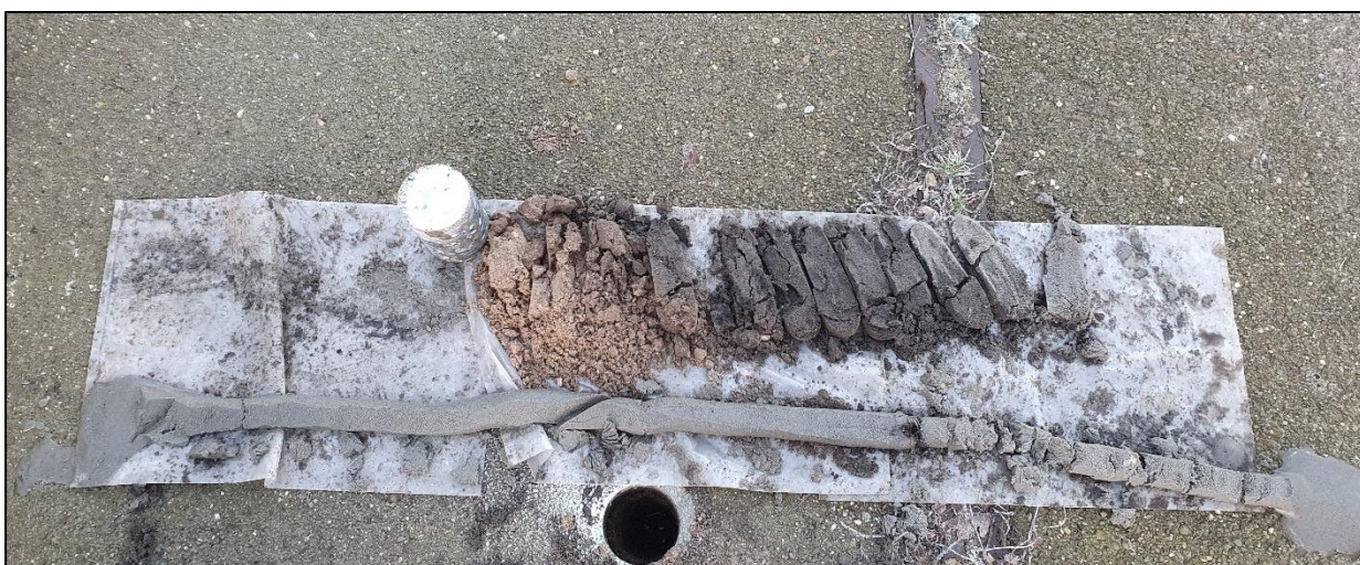
Boring 10 (geheel). Het diepste punt van de zuigerboor bevindt zich aan de rechterzijde.
